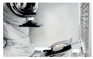
Innerhalb von 48 Stunden wird die NFC-Funktion am Prüfstand rund 10.000 Mal ausgelöst. ⊚ ASAP
